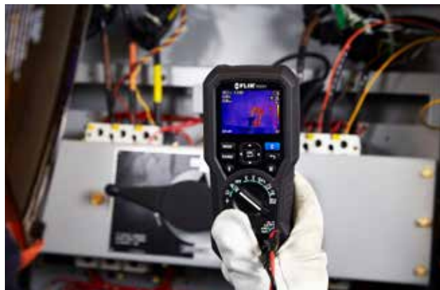
Exploración térmica de un cuadro eléctrico
